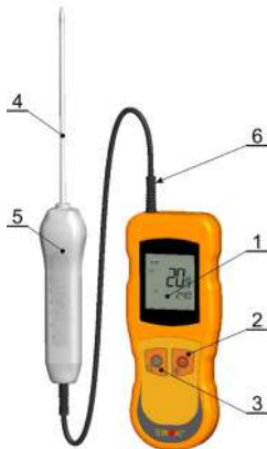
Рис. 1 Основные части прибора ТК-5.01С, органы управления
