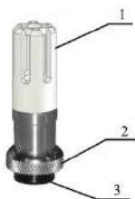
Рис. Б.18 Зонд давления атмосферного (ЗДА.8)
