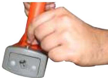
а) Выдвинуть фиксатор, освободить батарейный отсек
