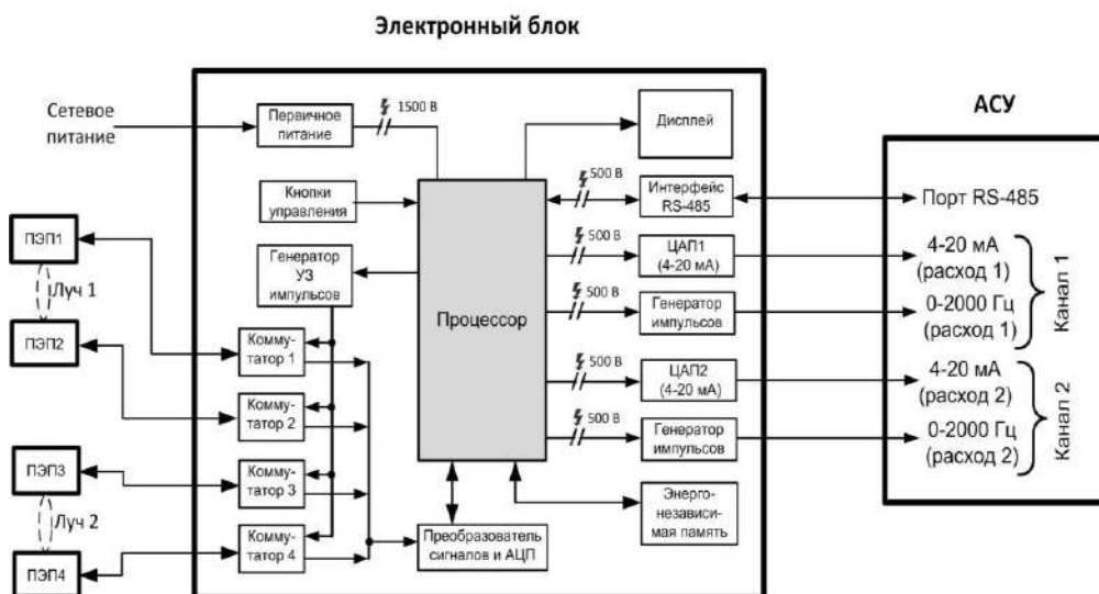
Рисунок 3.1 – Функциональная схема расходомера
