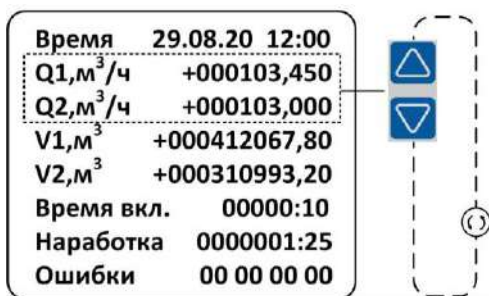
Рисунок 5.1 – Перемещаемое окно списка параметров 2-канального расходомера
