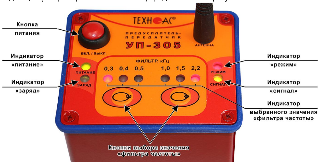
Рисунок 4 Органы управления и индикации «УП-305»
